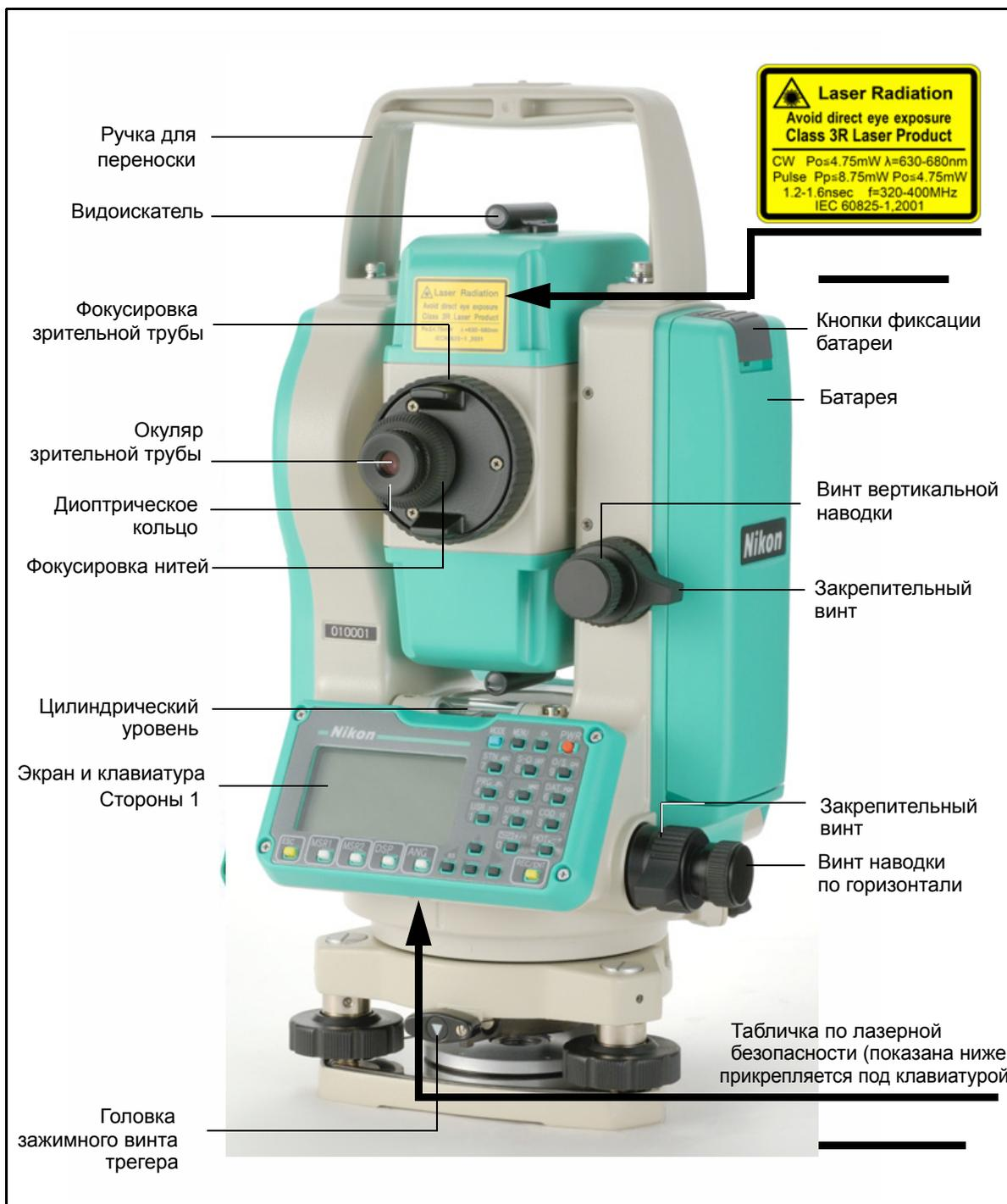
Рисунок 1.1 Электронный безотражательный тахеометр серии NPR-302 – Сторона-1
